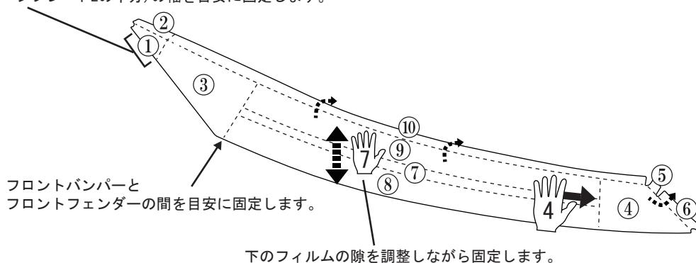
上下の隙のバランスを調整して固定します
