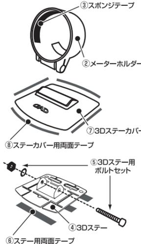
■ステー、ステッカー、メーターホルダーの順に付属のボルトセットで仮組しておきます。次に、メーター本体固定用スポンジテープを、メーターホルダーに貼付けてください。その後、先ほど仮組しましたメーターホルダーベースをお好みの位置に、付属の両面テープで取付ます。メーターホルダーの角度等が決まりましたらボルトを本締めします。(ステッカーのダッシュボード等への接着には付属の専用両面テープをお使いください。) ※スポンジテープは貼付ける長さで固定の強さが変わります。お好みの長さに調整してください。
