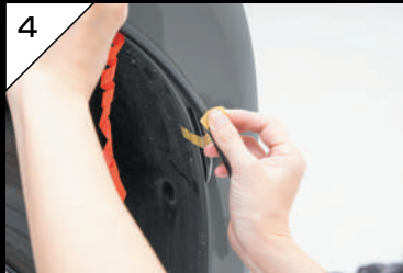
4 エンドパーツ付近までたどり着いたら、エンドパーツまでの距離をよく確認しながら、カットする位置にマスキングテープ等で目印をつけてください。
