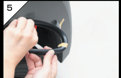
5 目印を付けたカット位置を頂点になるようにモールを曲げ、R(カーブ)の癖をつけます。
