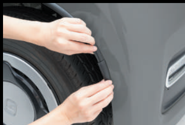
7 さきほどR(カーブ)をつけたカット位置でモールをカットし、フェンダーのRに沿って貼り付けます。これでモールの取付が完了です。
