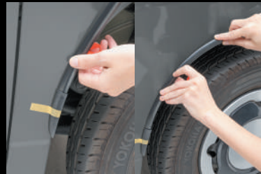
3 R(カーブ)がついた先端部から離型紙をめくり、仮止めしておいたエンドパーツにR(カーブ)がついたモールの先端を差し込みます。そのままフェンダーのRに沿ってモールを貼付けていきます。
