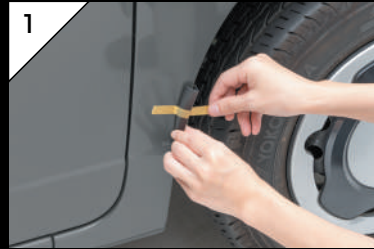
1 エンドパーツ(左右)を仮止めし、モールの開始地点と終了地点を決めます。
