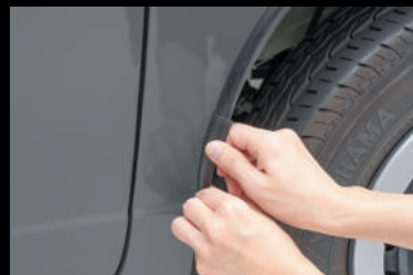
7 さきほどR(カーブ)をつけたカット位置でモールをカットし、フェンダーのRに沿って貼り付けます。これでモールの取付が完了です。
