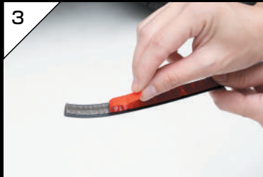
3 R(カーブ)がついた先端部から離型紙をめくり、仮止めしておいたエンドパーツにR(カーブ)がついたモールの先端を差し込みます。そのままフェンダーのRに沿ってモールを貼付けていきます。
