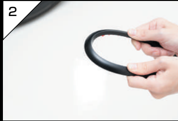
2 モールを曲げ、R(カーブ)の癖をつけます。十分にRの癖がついたら、Rの頂点でモールをカットします。
