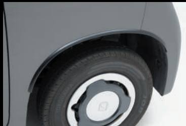
7 さきほどR(カーブ)をつけたカット位置でモールをカットし、フェンダーのRに沿って貼り付けます。これでモールの取付が完了です。
