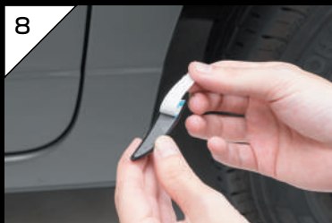
8 エンドパーツの離型紙をめくり、モールの両端に貼付けます。
