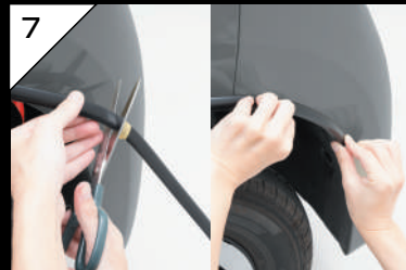
7 さきほどR(カーブ)をつけたカット位置でモールをカットし、フェンダーのRに沿って貼り付けます。これでモールの取付が完了です。
