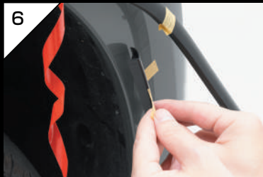
6 仮止めしていたエンドパーツを取外します。
